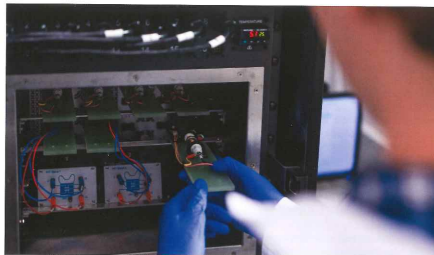
Vložení testovací cely do teplotní komory bateriového testeru Novonix.
